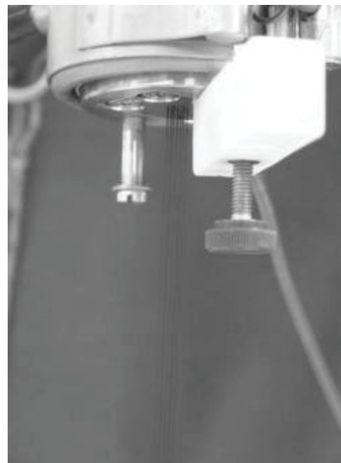
Abb. 11: Schema des verwendeten Spinnkopfes. Abb. 12: Realer Spinnversuch.
