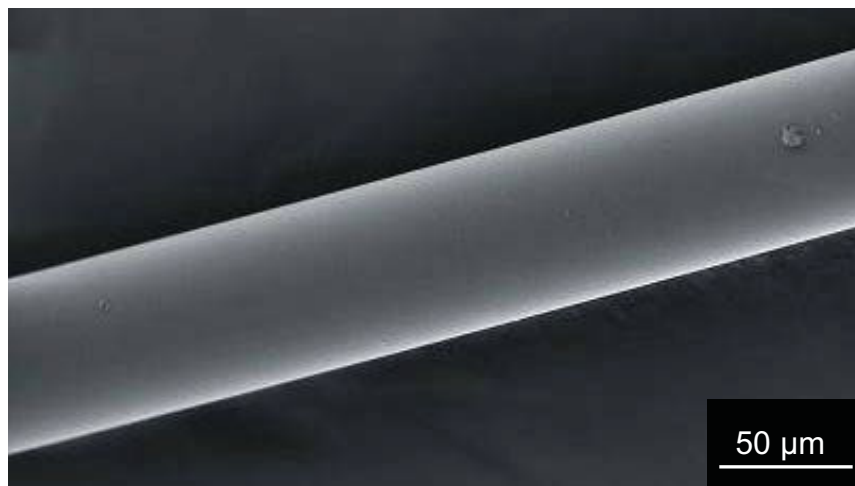
Abb. 32: REM-Aufnahme einer Grünfaser mit weniger als 1 Gew.% MWCNT und 1 Gew.% Dispergator.
