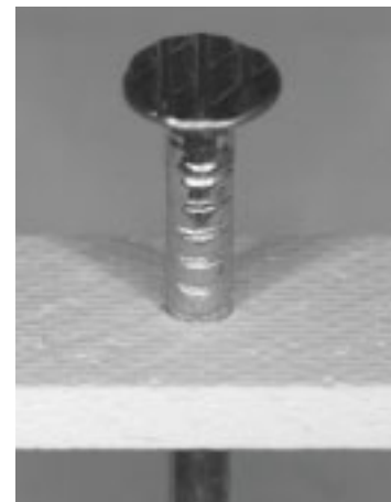
Abb. 2: Nagel in risszähem, oxidischem, langfaserverstärktem CMC [21].
