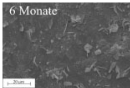
Abbildung 31. REM-Aufnahmen von Extrudaten mit 50% gemahlenem Praziquantel / 29% Lipid / 20% PEG 6000 / 1% Siliciumdioxid, Extrudatdurchmesser 0,3 mm, nach 6 Monaten Lagerung.
