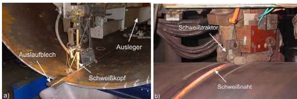
Bild 2.10: a) UP-Längsnahtschweißung an einem Rohrschuss b) UP-Umfangsnahtschweißung
