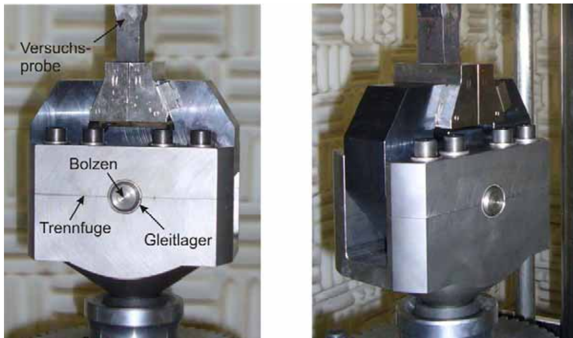
Bild 7.5: Probenaufnahme für die exzentrischen Dauerschwingversuche mit eingebauter Versuchsprobe
